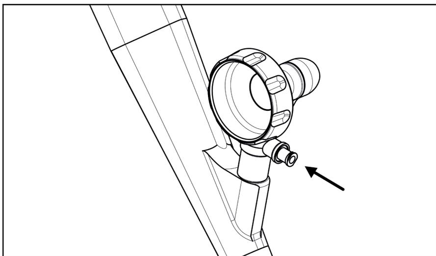
**Важно:** При необходимости промывания для прояснения эндоскопической картины, установите соединительную трубку в предназначенный для этого канал и впрысните стерильную воду.
